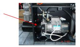
DO NOT OIL MOTOR PARTS: ALL PARTS ARE AUTO-GREASED.
